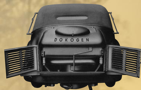
Škoda SUPERB s generátorem DOKOGEN r. 1943
